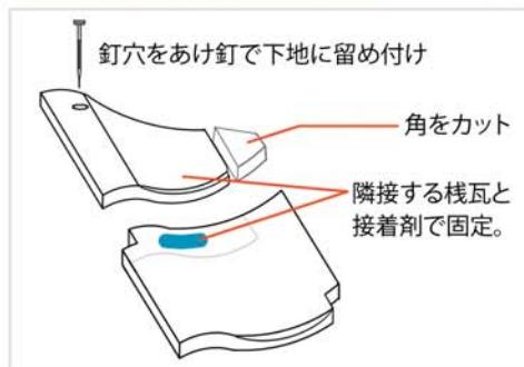
隅棟の勝手瓦は、瓦に沿って台土に雨水が浸入するのを防ぐため、図のように角をカットしてください。
