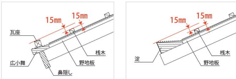
緩勾配屋根の施工に際しては、棟瓦と軒瓦の流れ勾配が同じになるよう、瓦座や淀の高さにご注意ください。上図は軒瓦の出が75mm、棟木の厚みが15mmの屋根における瓦座（または淀）の高さ（棟木の上面から15mm）を示しています。
