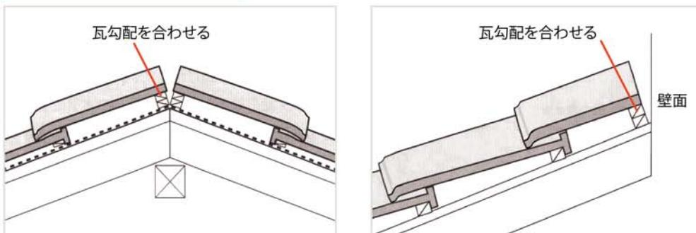
棟際、及び壁際で切断した棟瓦を用いる場合、緩勾配屋根では特に瓦勾配に注意して施工（棟木を重ねるなど）してください。
