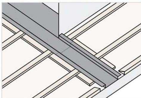
流れ壁際には、棟瓦の下にステンレス等の腐食しない捨て水切りを入れてください。
